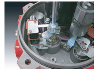
Finales de carrera - Acoplado directamente con el eje de transmisión para establecer la posición precisa de la válvula. - 2 interruptores de posición por recorrido (abierto cerrado). - Interruptores de límite adicionales opcionales (máximo 4 para cada extremo): Excepto por EKQ0060-0100
