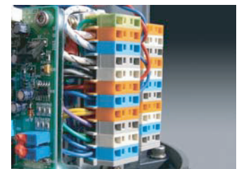
Terminal - Terminal tipo empuje con resorte para una conexión de cableado firme.
